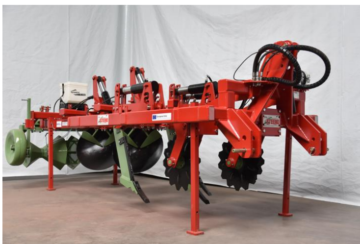
Groasis Terracedixx para crear mini-terrazas de 15.000 metros/hora
